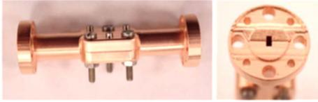
Fig. 8. W-Band SLA split-block MPRWG [5].
