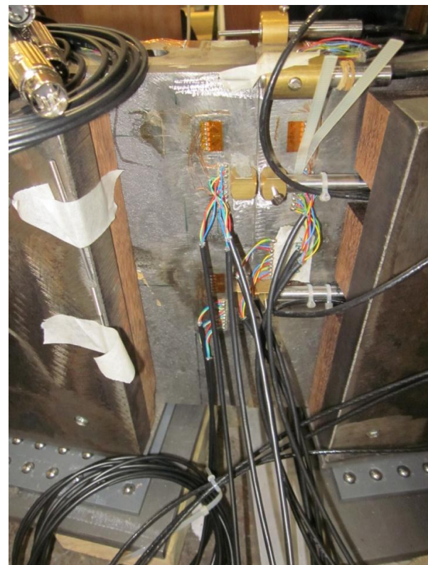
LVDTs on extrados
