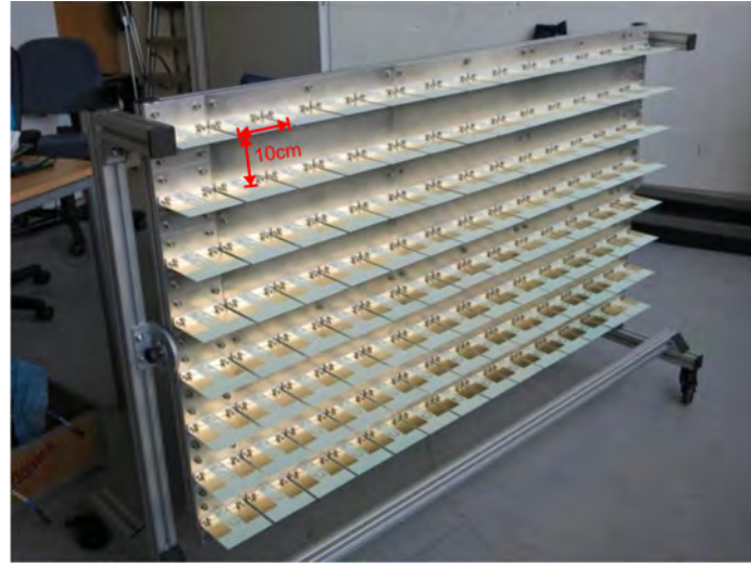
(a) SAAB's actual array of 96 antennas
