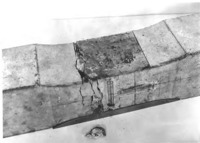
Fig. 11.5.7. Biaxial Compression-Tension Fracture D.
