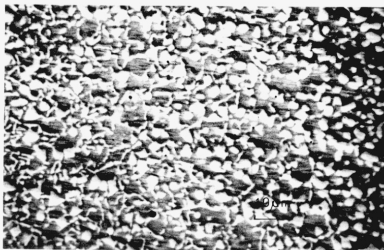
Fig. 57: As-Cast 1 1/2 wt % Si / 5wt % Fe (SEM)
