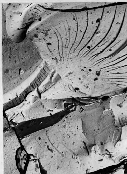
(d) Ground with 600 mesh carborundum
